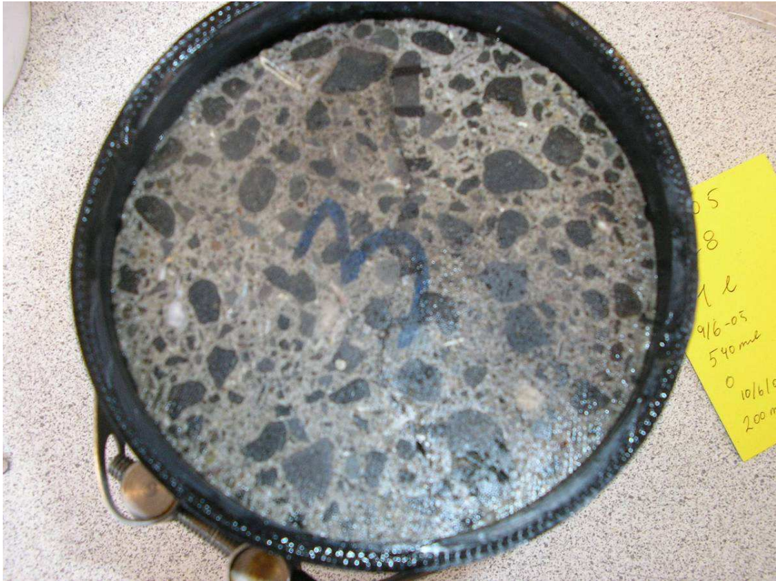
Mynd 15. Sýni 3. Töluverður leki var í sýninu. Sprungan liggur upp-niður eftir miðju sýninu.
