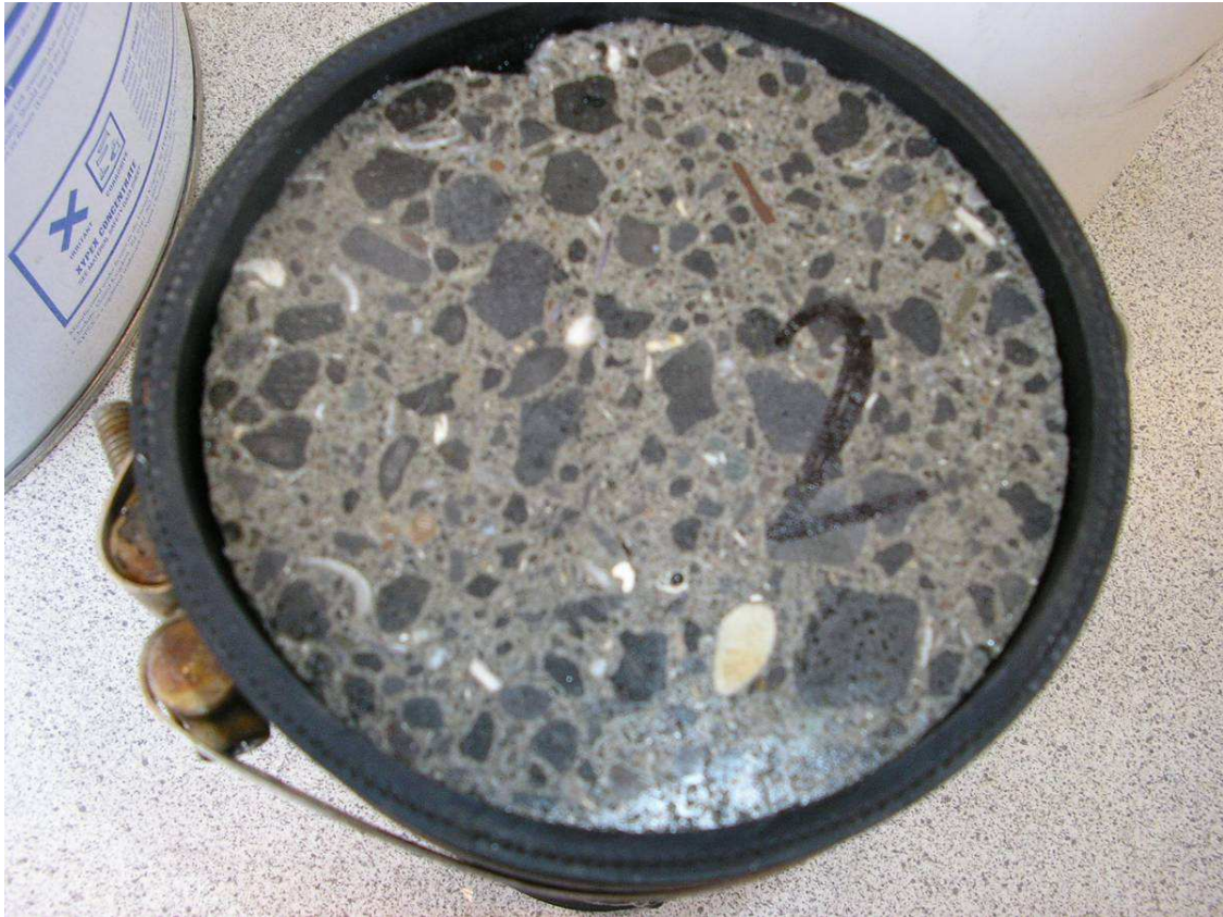
Mynd 14. Sýni 2 eftir um 3 sólarhringa var sýnið aðeins yfirborðsblautt. Sprungan liggur upp-niður efir sýninu miðju, en sprungan sést ekki vel vegna þess að myndi er ekki í fókus.
