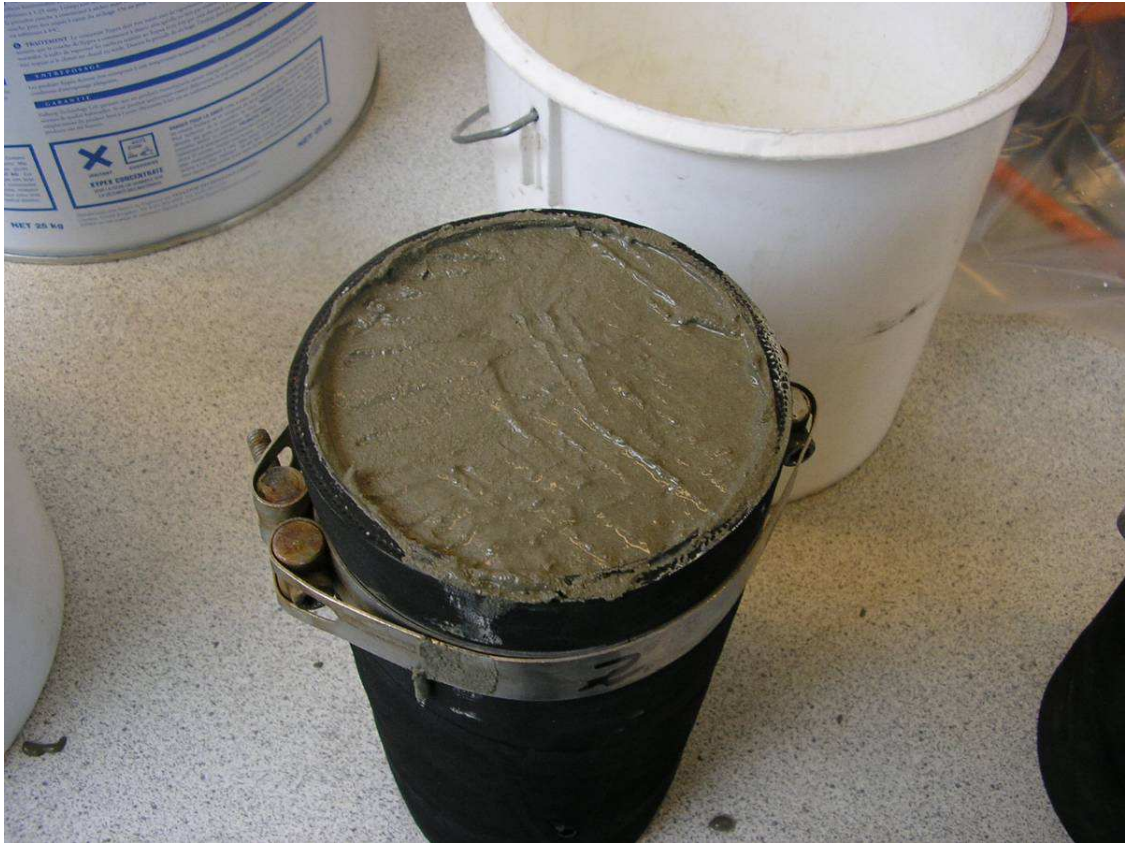
Mynd 16. Sýni 2 með um 3 mm þykku lagi af XYPEX (down-stream)
