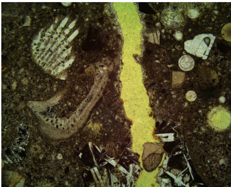
Mynd 62. Smásjármynd af sprungur í sýni 4584 án XYPEX.
