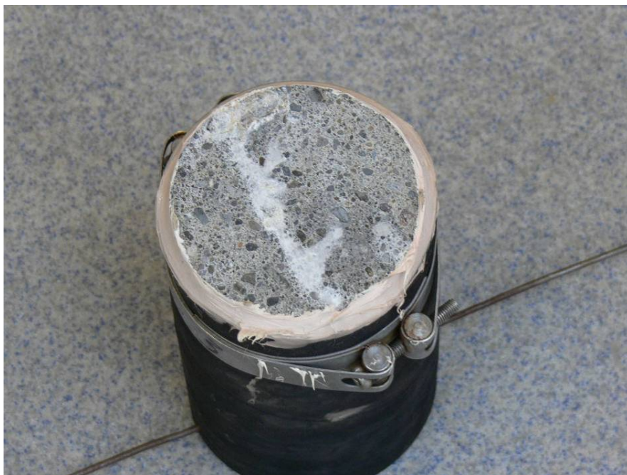
Mynd 76. Sýni 4510-1 eftir að prófun lauk. Sjá má hvíta útfellingu í sprungunni
